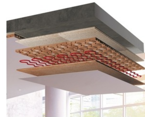
Aufbau der Natur-Klimadecke aus OSB/ESB-Spanplatten oder zementgebundenen Spanplatten, Lehmmodulen, Lehm- und Rohrleitungen und Oberflächenbeschichtung. (Bilder: Argilla Therm)
