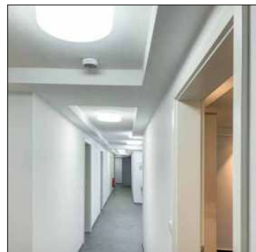
Durch die Fähigkeit der Natur-Klimadecke zur Feuchteregulierung ist im sommerlichen Kühlbetrieb keine Anlage zur Raumluftentfeuchtung nötig.
