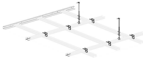
Metallabhängung in Leichtbauweise
