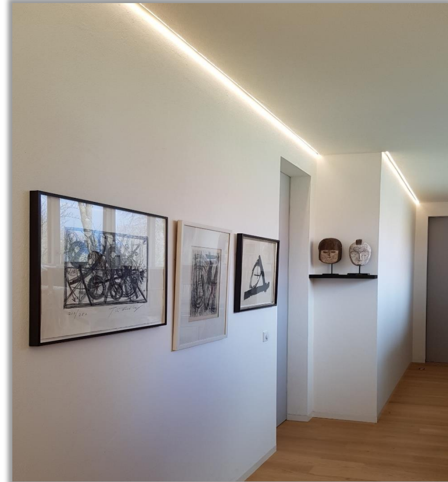
Vollflächige Deckenbelegung mit raumumlaufender indirekter Beleuchtung
