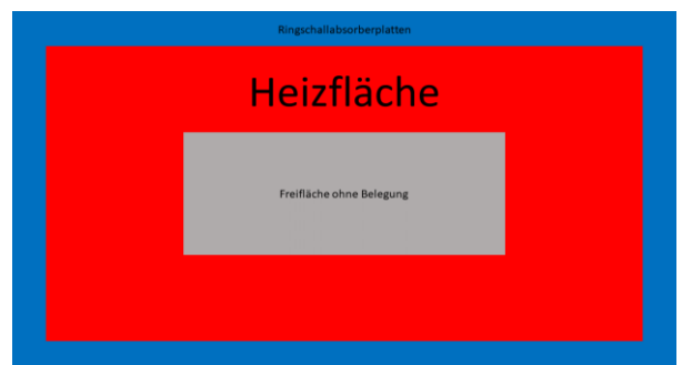
Deckensegel außenliegend mit Ringschall-Absorberplatten
