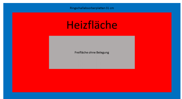
Deckensegel außenliegend mit Ringschall-Absorberplatten
