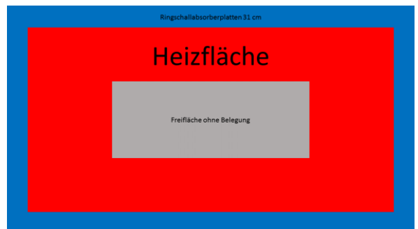
Deckensegel außenliegend mit Ringschall-Absorberplatten
