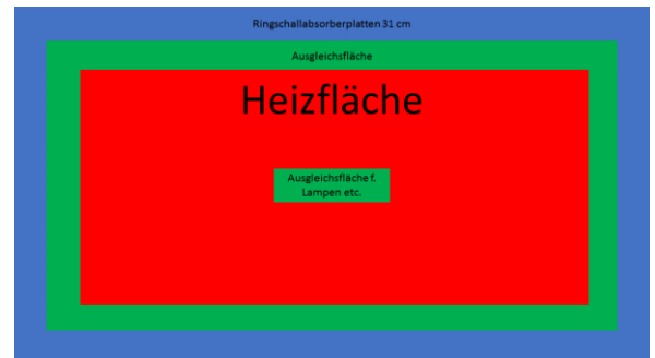
Geringere Heizleistung mit Ringschall-Absorberplatten
