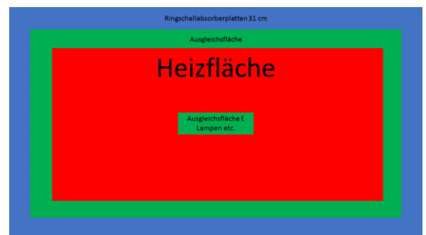
Geringere Heizleistung mit Ringschall-Absorberplatten
