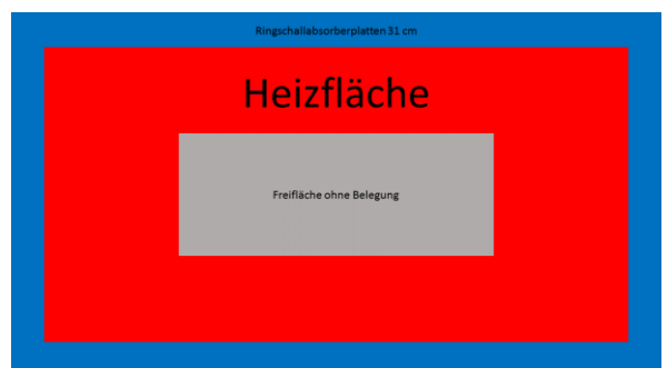
Deckensegel außenliegend mit Ringschall-Absorberplatten
