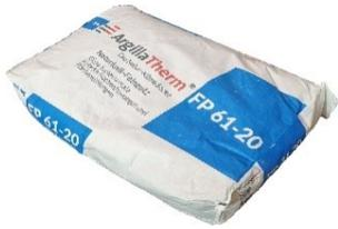
Naturkalk-Feinputz 61-20 – nach DIN 998-1 auf Luftkalk-Basis ohne Zementzusatz, mit Kalksteinbrechsand 0 bis 0,8 mm als Trockenware, 1 Sack á 25kg für ca. 6 m<sup>2</sup>
