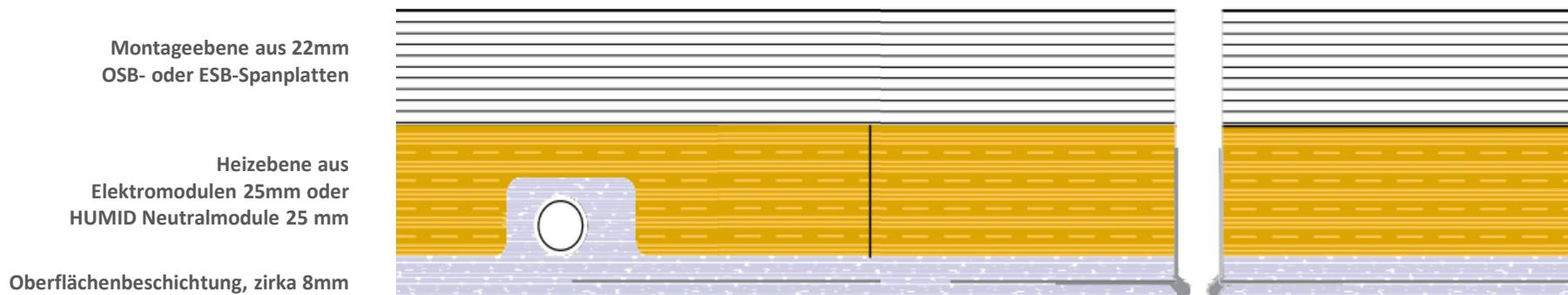
Bewegungsfugen aus dem Baukörper müssen bei kraftschlüssiger Montage der Klimadecken in allen Ebenen übernommen werden (z.B. bei direkter Befestigung der Montageebene an der Rohdecke oder an Holzlattungen).
